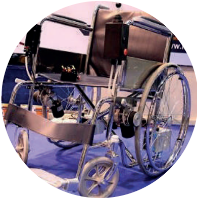
M-Wheel อุปกรณ์พ่วงต่อปรับรถเข็นทั่วไป เป็นรถเข็นไฟฟ้า
